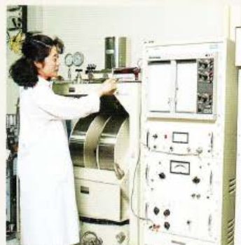
振動試料型磁力計(VSM) / 試料に特殊な振動を加えて磁気特性を精密に測定。
