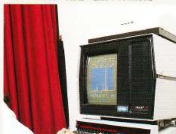
X線微小解析(XMA) / 電子ビームにより試料から出てくるX線で定性解析、分散性などチェック。
