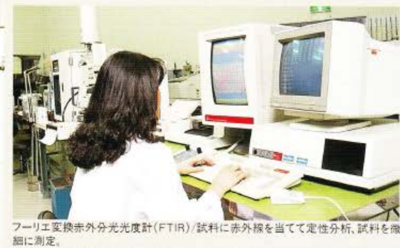
フーリエ変換赤外分光光度計(FTIR) / 試料に赤外線を当てて定性分析、試料を微細に測定。
