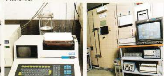
液体クロマトグラフ・GPC / 原材料の有機物分析やポリマー分子量分布を測定。
