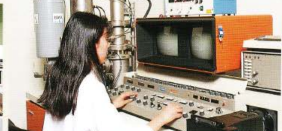
走査電子顕微鏡(SEM) / 電子ビームを試料の表面に当てて何万倍もの倍率で微細な現象を測定。
